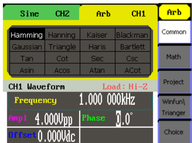
图 2-19 窗函数\三角函数内建波形显示界面
