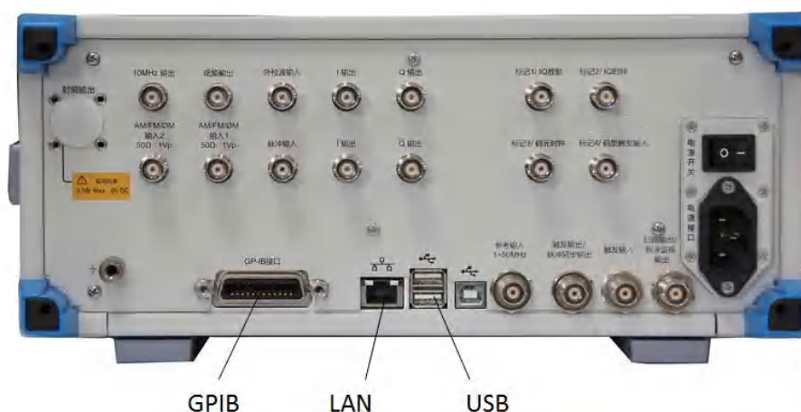
图 2.23 1435 系列信号发生器程控接口
