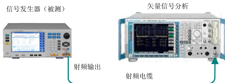
图 8.8 EVM 和原点偏移的测试
