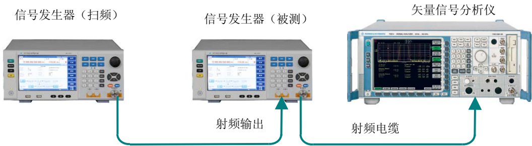
图 8.9 外部调制频响的测试
