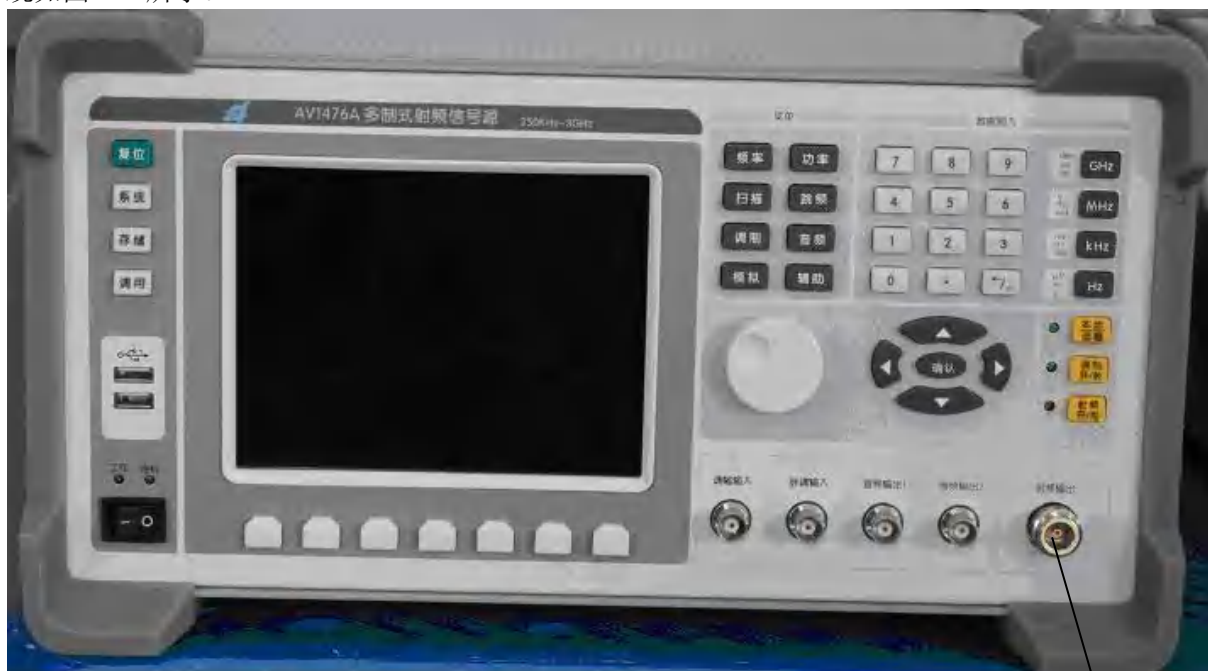
图 2-1 AV1476A 多制式射频信号源外观图
