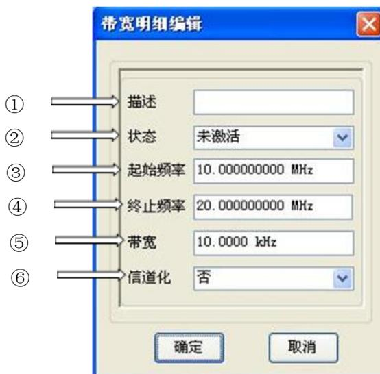
图 3-68 带宽明细编辑对话框
