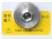
当输入衰减器的设置不小于 10dB 时，射频输入端口输入信号最大功率为+30dBm。禁止输入直流信号，否则会造成仪器内部器件的损坏！
