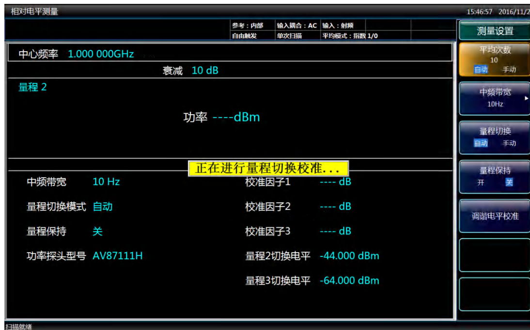
图 4.9 量程 2 的校准过程
