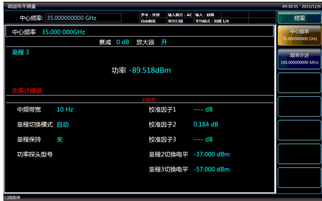
图 4.12 在量程 3 内的测量结果
