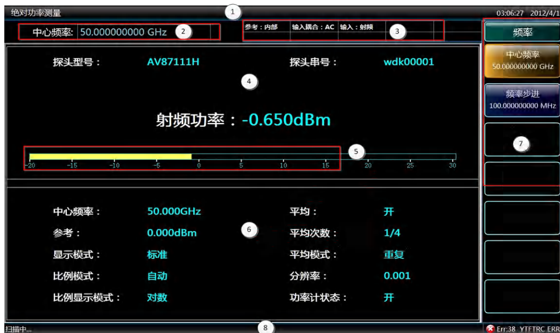
图3.17 绝对功率测量显示界面
