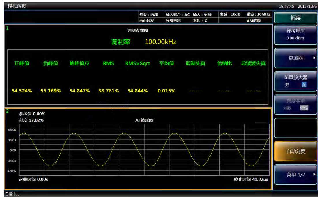
图 4.15 AM 信号时域测量波形
