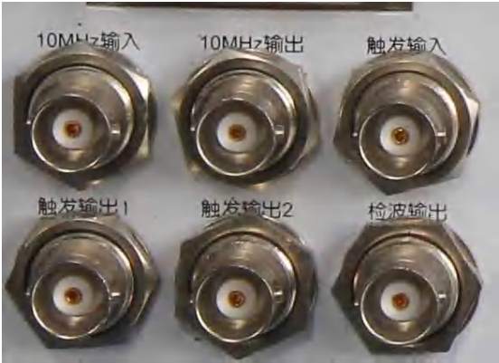
图 3.15 后面板 BNC 接口输入输出
