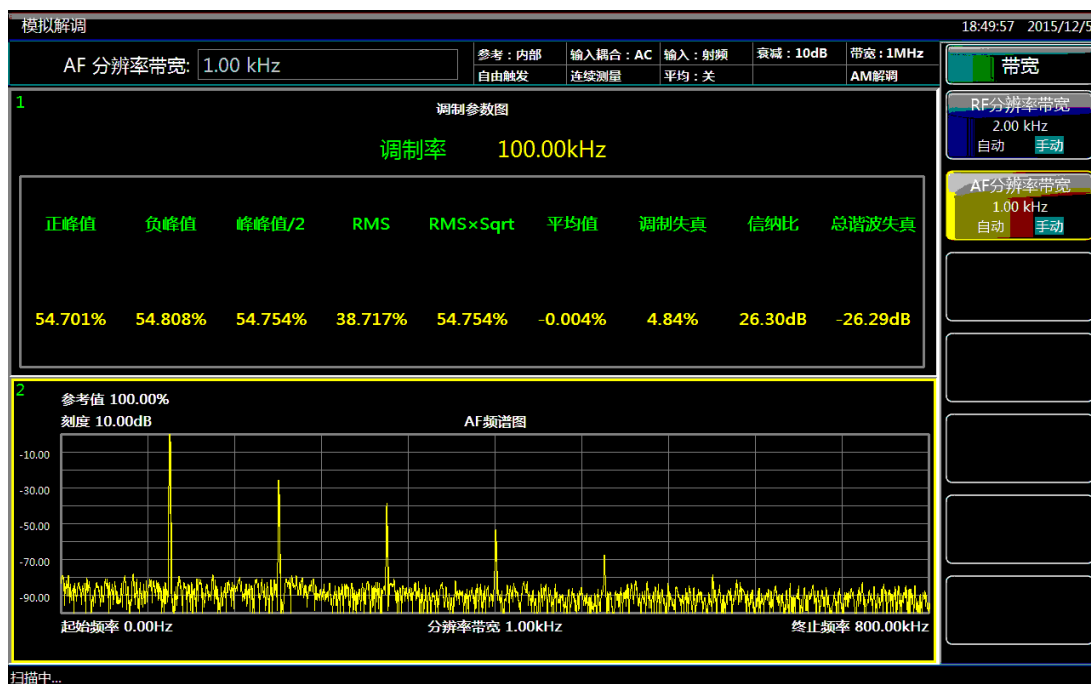
图 4.17 AM 信号基带频谱图
