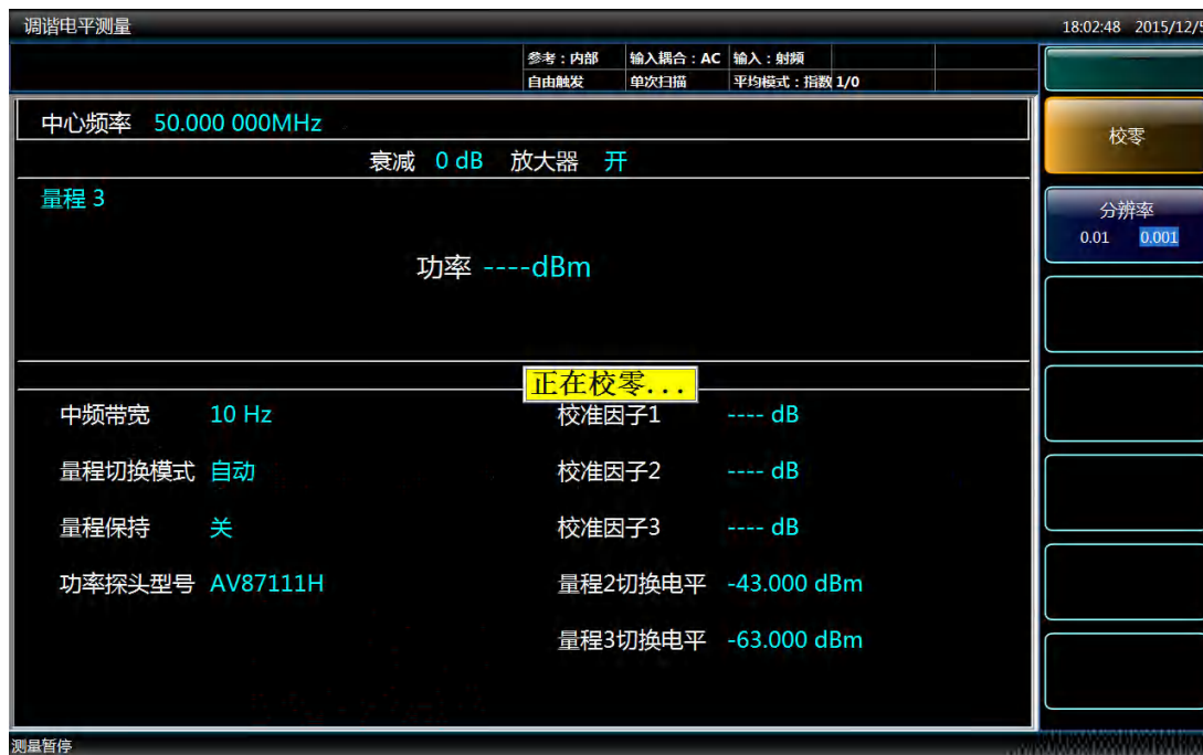
图 4.7 功率计校零操作
