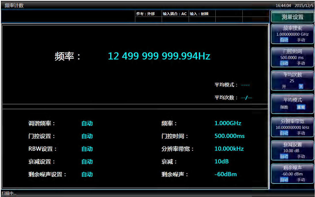
图 4.2 频率计数测量结果
