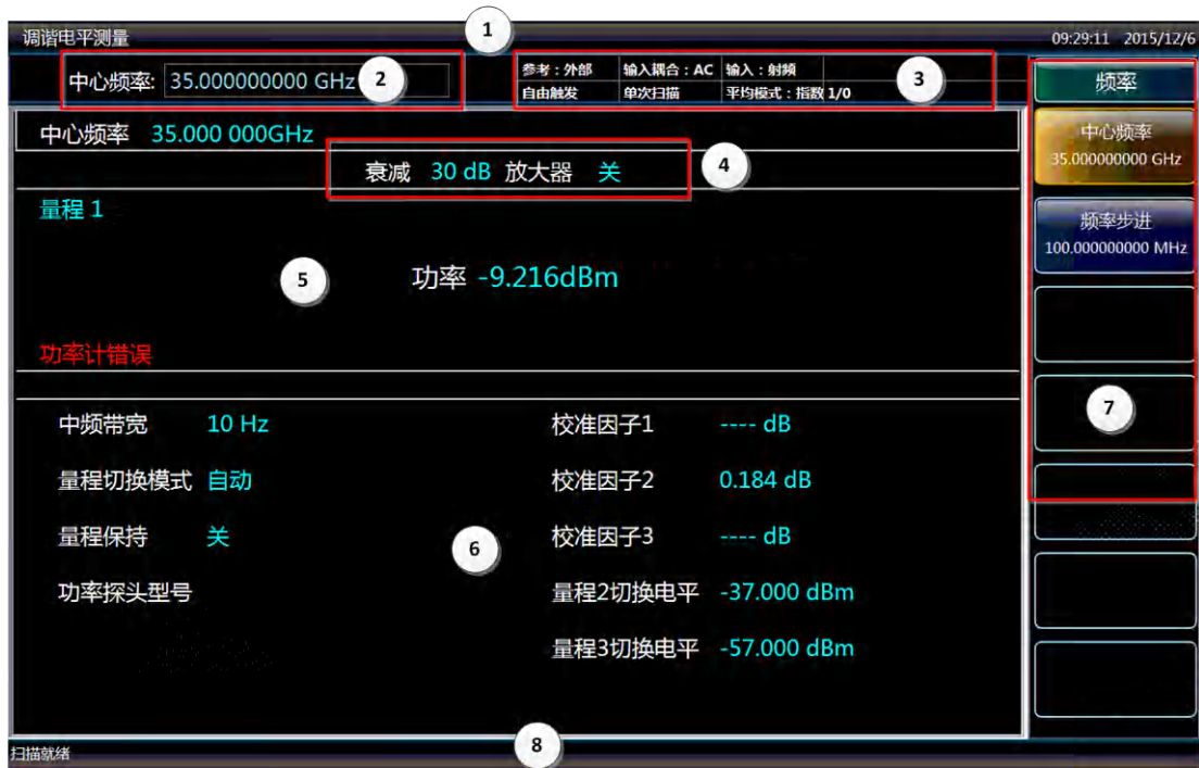
图3.18 调谐电平测量显示界面
