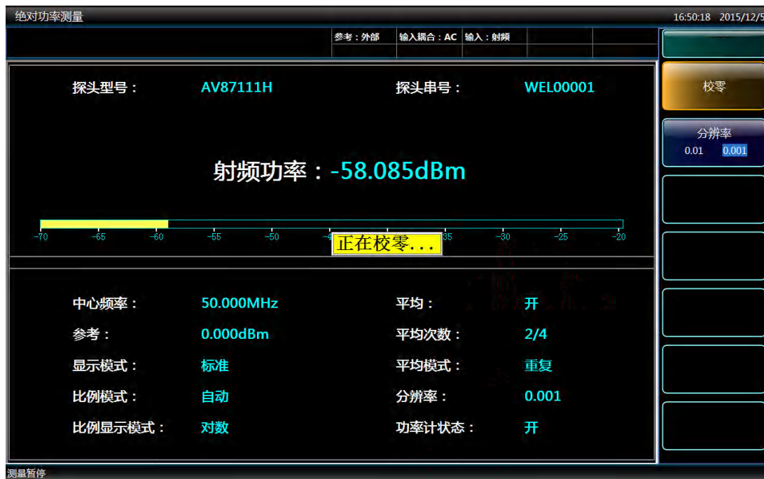
图 4.4 功率计校零操作
