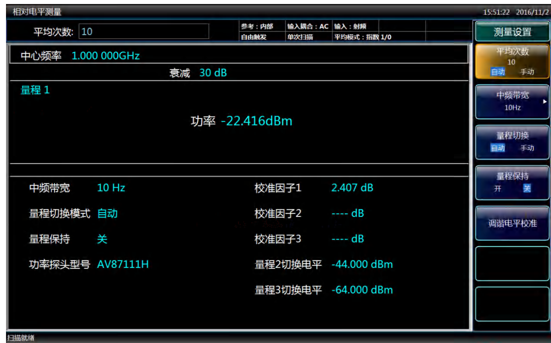
图 4.8 调谐电平的测量结果
