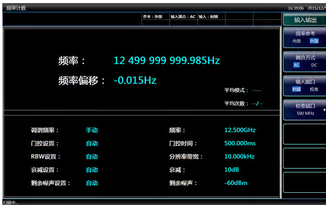
图 4.3 频率偏移测量结果
