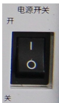
图 3.2 3927 后面板电源开关
