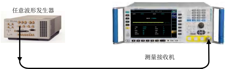
图 8.3 FM 调制测量示意图
