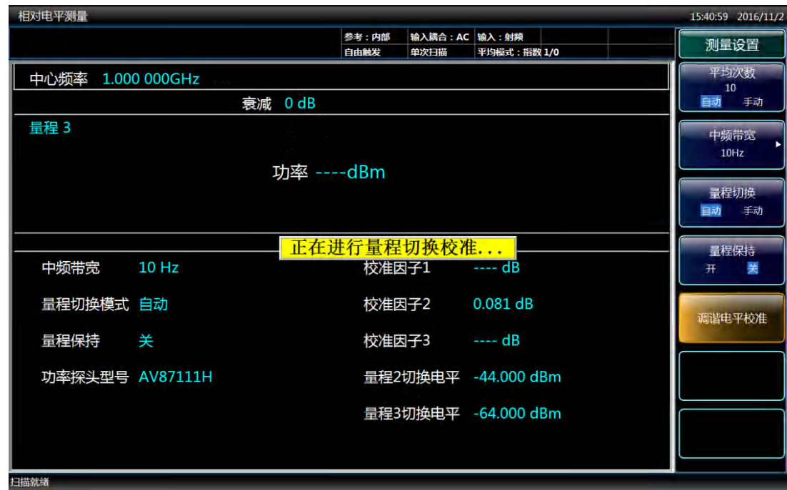
图 4.11 量程 3 的校准过程
