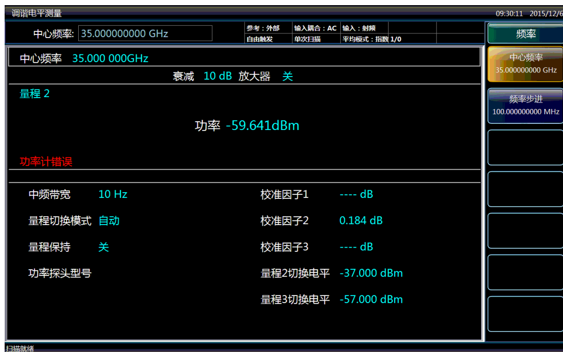
图 4.10 在量程 2 内的测量结果
