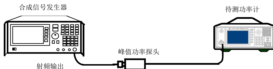
图 8.1 主机上升时间测试框图
