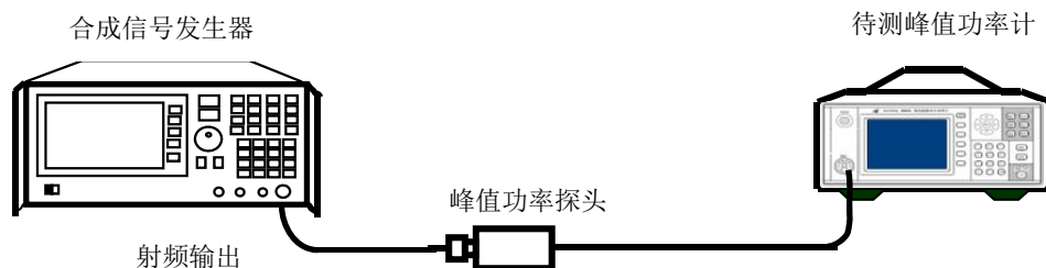
图 8.9 峰值功率探头上升时间测试框图
