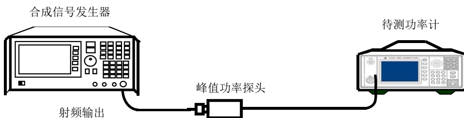
图 8.2 内部触发电平的测试框图
