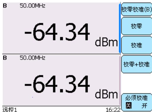
配接峰值功率探头时，即为高性能的峰值功率计。能够对脉冲调制信号进行幅度和时域参数的测量分析。
