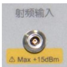
图 5-5 射频输入端口
