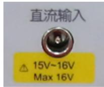
图 5-6 电源输入端口
