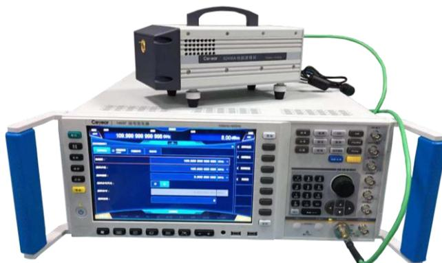
图 8-1 毫米波太赫兹与太赫兹倍频源系统
