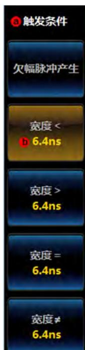
图5.15 欠幅触发条件设置菜单
