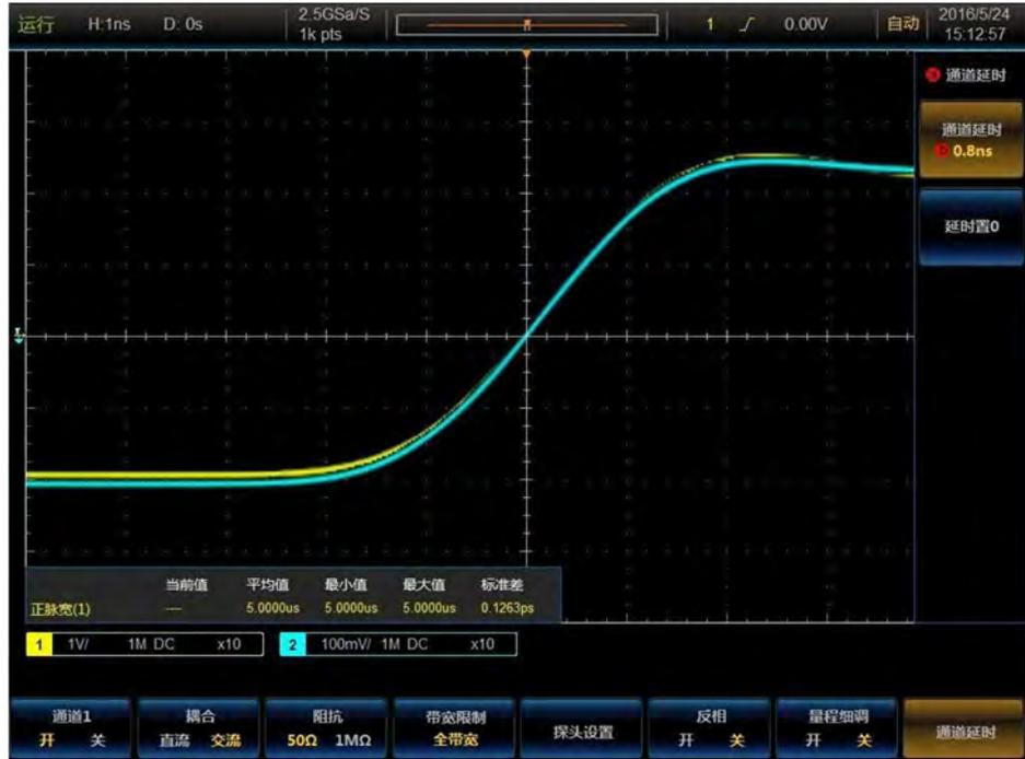
图3.14 通道延时校准示例
