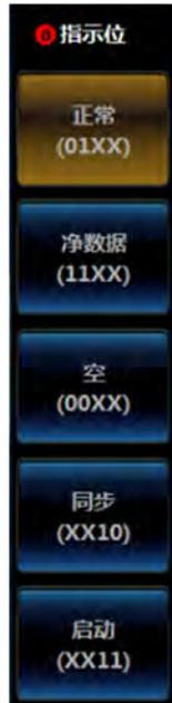
图11.145 FlexRay 总线指示位触发类型设置菜单
