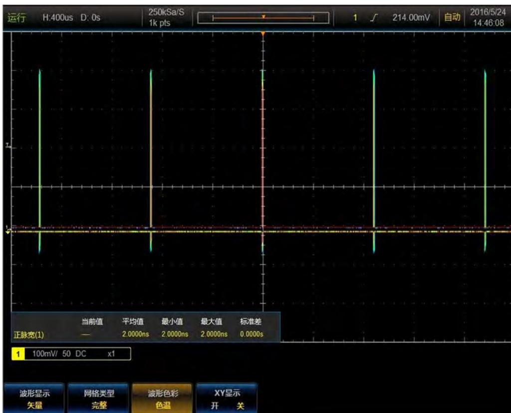
图15.2 采用峰值模式测量脉冲示例
