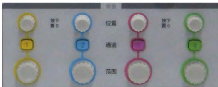
图3.1 示波器垂直操作区
