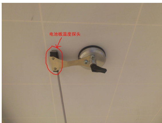
图 4-3 方形温度探头安装
