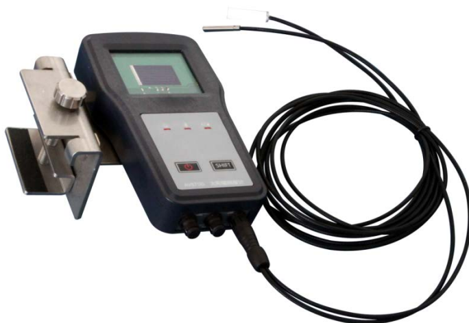
图 4-1 太阳辐照度计固定
