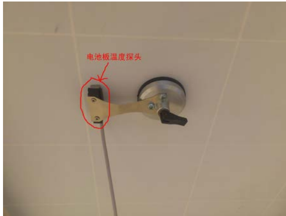
图 4-3 方形温度探头安装示意图
