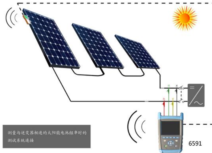
图 4-7 光伏电站中电池组串测试示意图
