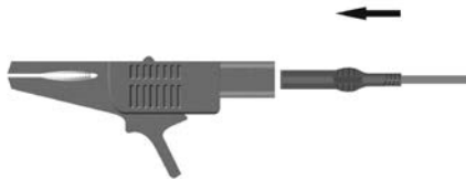
图 4-5 测试线与鳄鱼夹连接示意图
