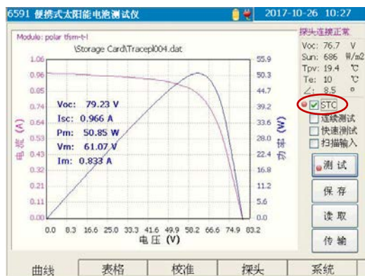
转换为 STC 下的测试曲线
