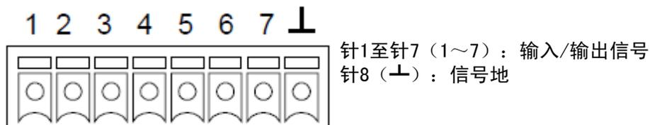
图 5-7 数字 I/O 接口引脚定义
