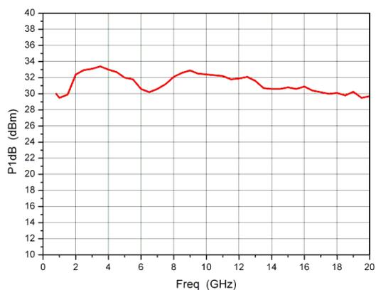
1dB 压缩输出功率 VS 频率
