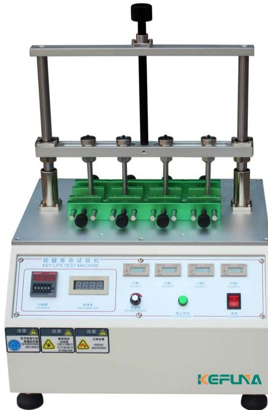
KAJ-5614D 按键寿命试验机适用于手机、电脑、电子词典、蓝牙耳机、车载播放器、摇控器按键、车辆防盗器、传真机按键、MP5、MP4、MP3、按键开关、轻触开关、薄膜按键、橡胶按键、硅胶按键等各类按键进行寿命试验。本机是将产品分别置于对应工位的试验位置上，按键测试杆在一定的试验荷重、速度、行程、次数下模拟人对产品的使用寿命测试。
