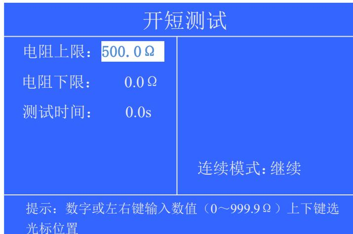
图 5.14 开短测试设置
