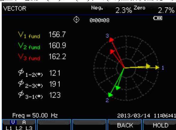
图 2-5-1 正确连接的分析仪向量图
