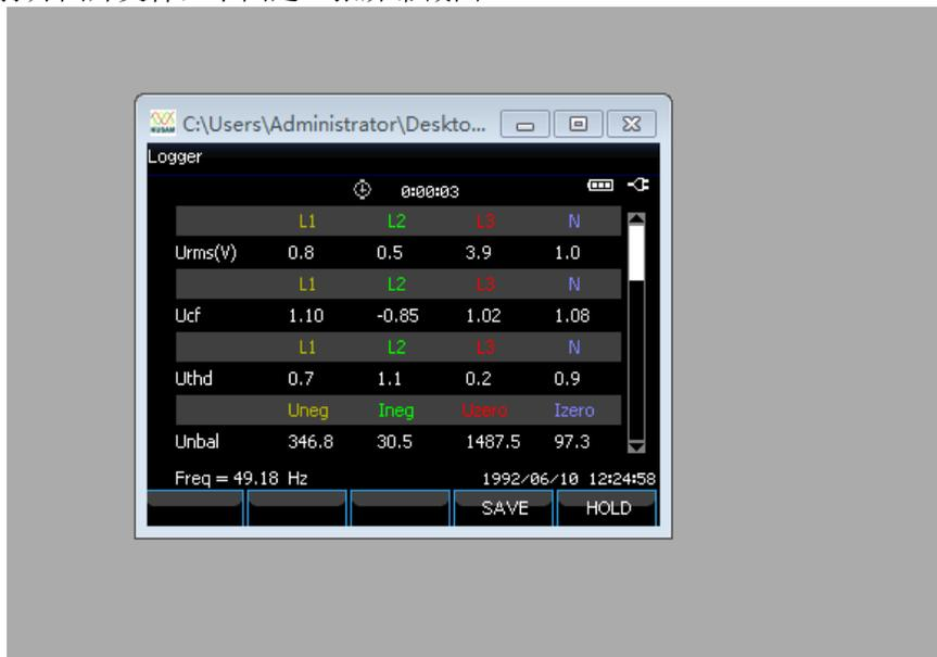
(2) 打开数据文件，下面是电压电流频率测量功能下存储的一个数据文件
