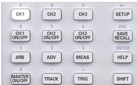
Abb. 4.2: Numerische Tastatur mit Funktionstasten
