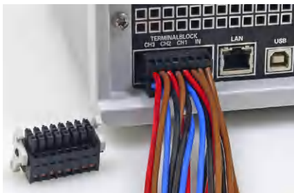
Abb. 6.2: Anschlussbeispiel einer Steckklemmleiste
