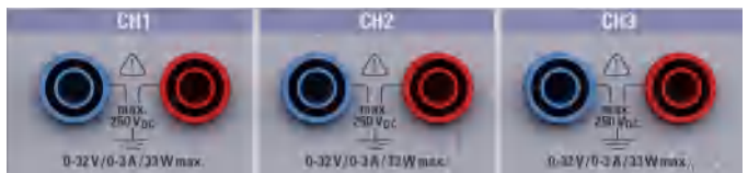
Abb. 1.3: Sicherheitsbuchsen auf der Gerätevorderseite
