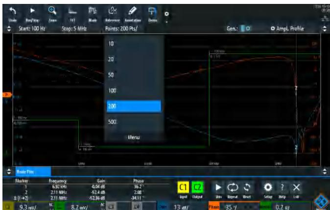
测量结果表格包含每个测量点的详细信息，包括频率、增益和相移
