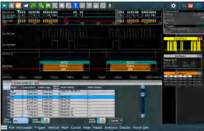
数字通道非常适用于触发和解码SPI等低速串行接口
