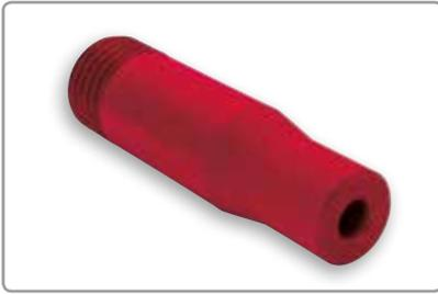
该喷嘴经久耐用，采用氮化硅内衬，喷嘴重量约降低了50%。喷嘴配有橡胶垫片，具有耐高温性，并对许多酸和碱具有耐腐蚀性。此外，缩醛护套也提供了较好的抗冲击保护。
