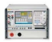
实现功率、电能全面校准的新式校准源
