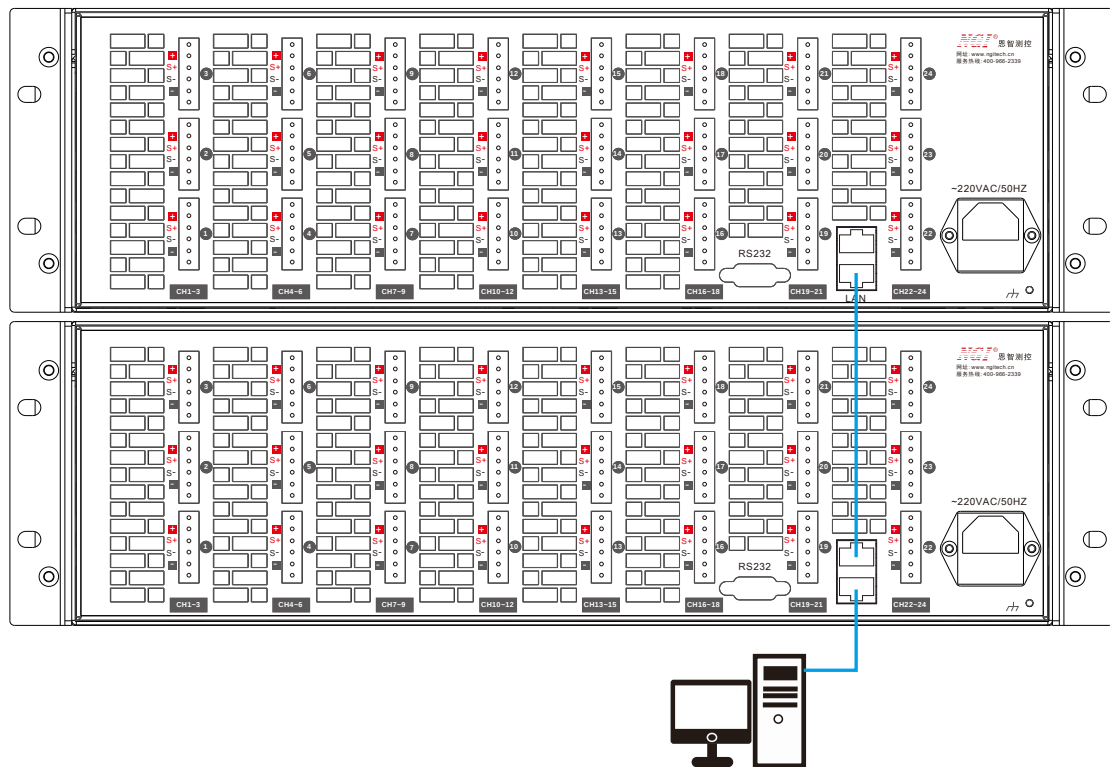
图 5-2 多机控制接线图
