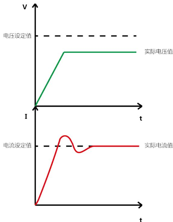
图 22 CV 优先模式给低阻抗负载供电
