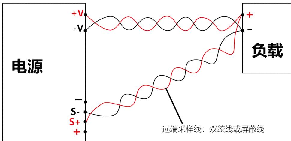
图 14 负载远端连接图
