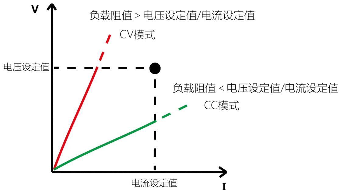
图 21 电源工作模式与负载阻值关系
