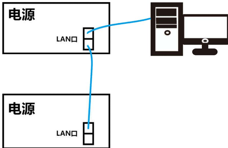
图 26 多机控制接线图
