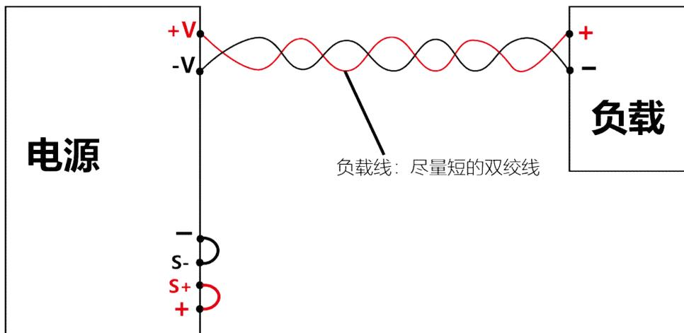
图 13 负载近端连接图
