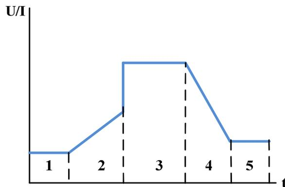
图 17 序列测试输出电压电流波形示意
