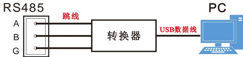
图 3-11 RS485 通信接线示意图
