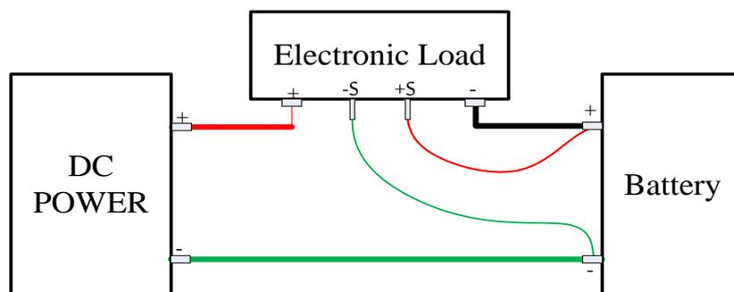
图 4-10 充电测试接线示意图
