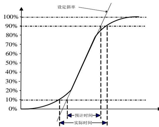
图 4-13 斜率与实际转换时间的关系
