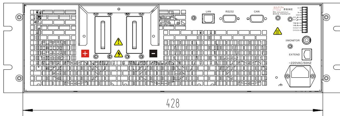
图 3-4 主机背面板尺寸图（mm）
