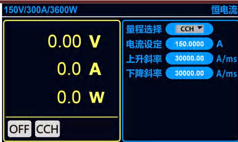
图 3-7 负载电压电流监视界面
