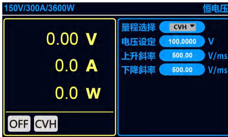
图 6-2 恒电压工作界面
