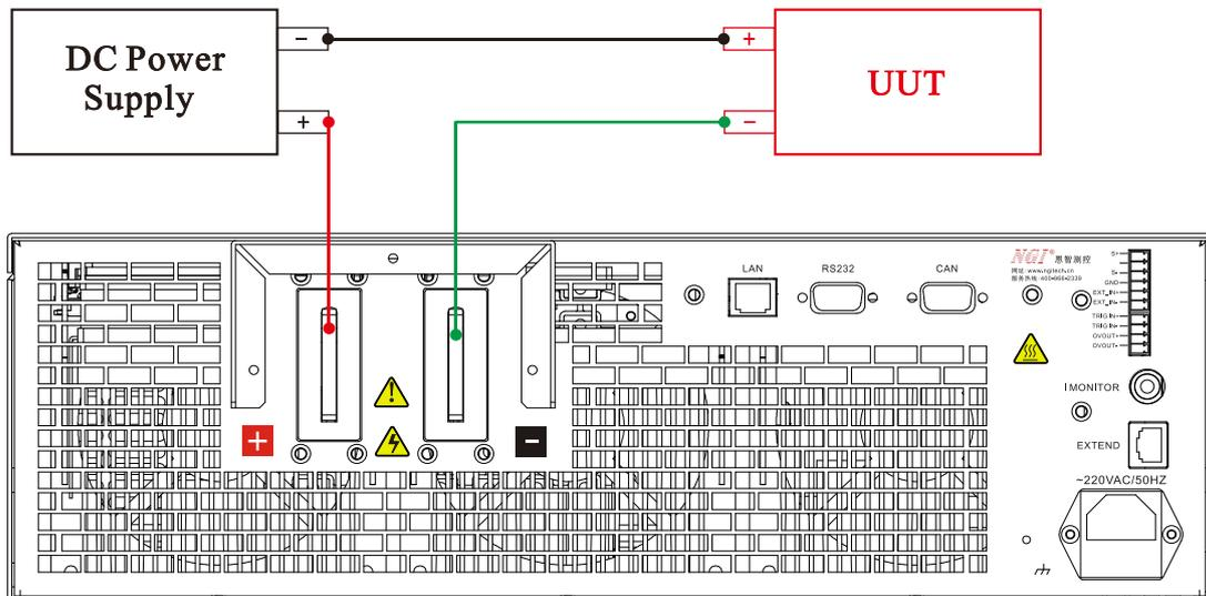
图 3-10 低电压操作
