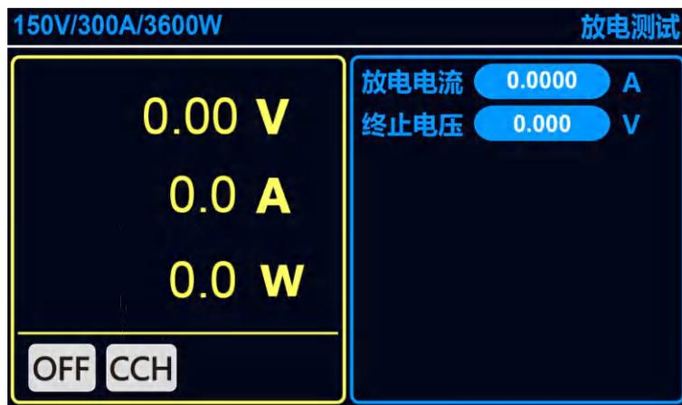
图 6-14 放电测试工作界面
