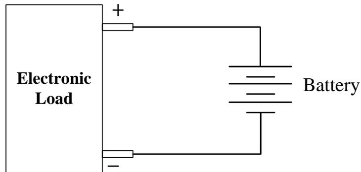
图 6-13 电池容量测试连线图
