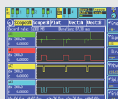
非常高的峰值电流同时出现在开关变换的边缘
