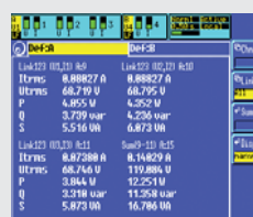
星型连接绕组的计算值
