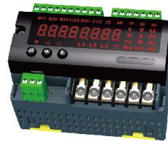
导轨式综合电能表采用35mm DIN标准导轨安装(DIN EN50022标准)，能与各类终端配电箱完美结合；对电能进行精确测量，进行电能计量和管理。产品符合IEC 62053-11标准；适用于政府机关和大型公用建筑中对电能的分项计量，也可用于企事业单位作电能管理及能效考核使用。可以测量电压、电流、功率、功率因数、频率等电参量，设置时钟、费率时段等参数。
