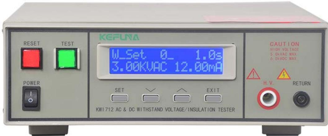
KWI 712 耐压测绝缘测试仪；交流耐压（电流）测试所需的正弦波电压（电流）是采用线性功放推动输出，具有输出波形纯净、失真度小的优点。这些测试仪全部采用 32bit ARM 作为主控制器进行设计，其输出电压的大小、频率及电压的上升、下降完全由 MCU 控制；能实时显示击穿电流值和电压值；配备 PLC 所需的信号输入、输出接口，可方便地与 PLC 组成综合测试系统。
