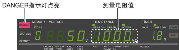
图 3-8 测试中的显示示例
