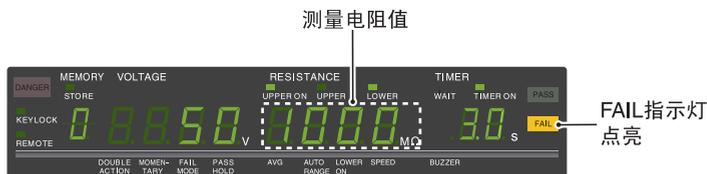
图 3-11 FAIL 判定时的显示示例
