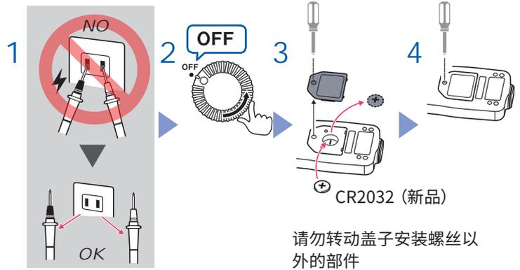
拆下电池盖之后, 可看到本仪器上安装的螺丝 (×3)。请勿转动螺丝。否则会导致无法进行正确的测量。
