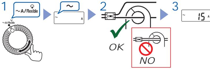
利用 CT6280 AC 柔性电流钳 (选件) 进行测量
