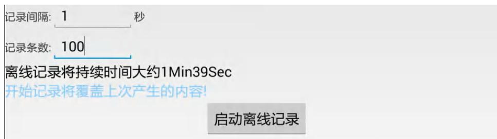
(3) 设置记录间隔与记录条数。记录条数最多可设为 10,000。设置后，点击 **启动离线记录**。万用表机身内存储区内只可存储单次离线记录的数据，因此，当开始记录后，上一次万用表内存储的离线记录数据会被覆盖。
