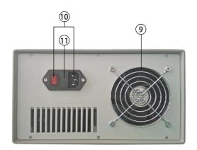
⑨散热风扇: 吸出型, 使用 24V/DC/0.15 A
