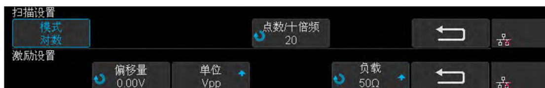
图 173 可变幅度扫描和激励设置菜单
