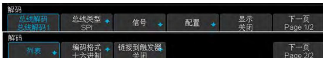
图 62 SPI 解码设置菜单
