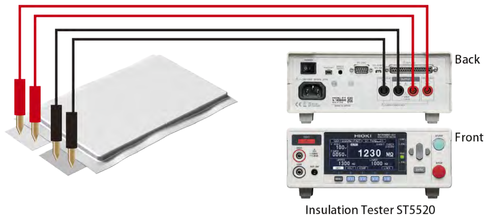
图 13 使用绝缘电阻试验机 ST5520 进行电池单体的绝缘电阻检查
