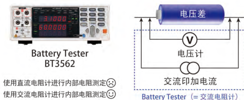
图 26 使用电池测试仪 (交流电阻计) 进行电池内部电阻测量
