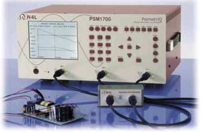
PSM1700 测试开关电源环路特性
