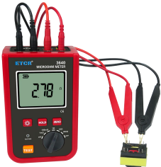
变 压 器 线 阻 测 量
