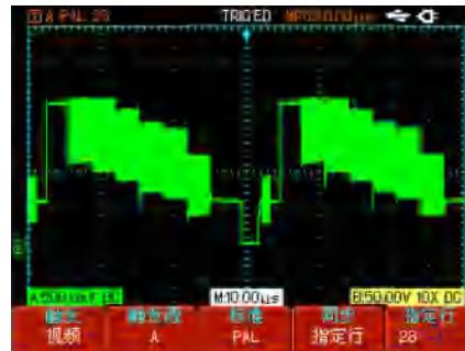
图2-17视频触发: 行同步
