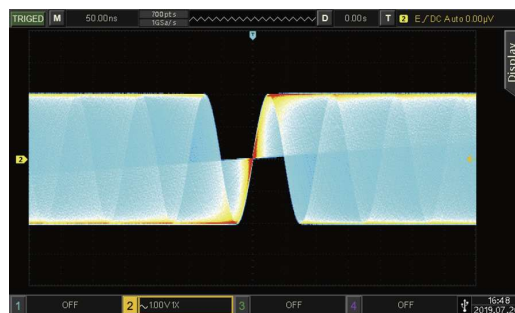
2 256级波形灰度显示, 及时体现波形出现的概率大小
