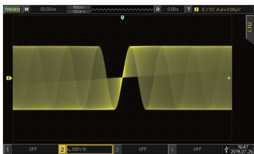
3 高达83,000wfms/s波形捕获率, 大大提高了捕获及低概率事件的能力, 可更直观的观察信号抖动和毛刺
