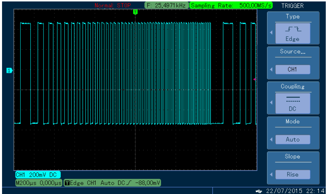
图 4-134 示波器观察扫频波形
