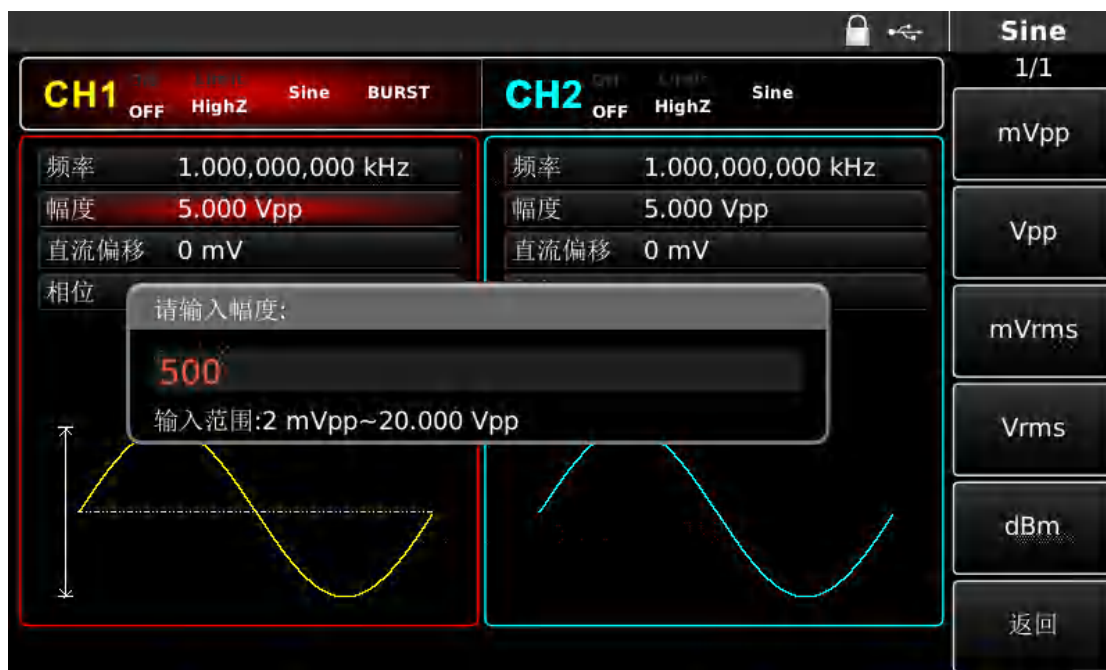
图 4-145 设置波形幅度
