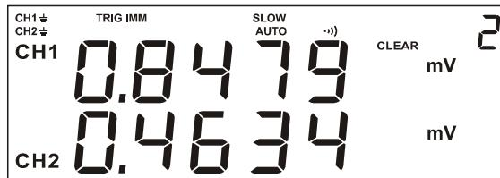
在回读模式下，长按CLEAR键后，LCD的“CLEAR”符号开始闪烁、LCD右上角显示“ALL”，此状态表示询问用户是否删除存储的所有记录。此时，短按OK键删除所有记录、短按ESC键取消删除。如下图所示：
