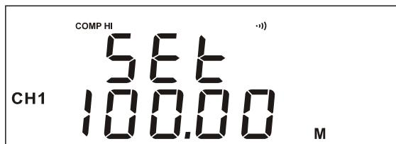
短按左键、右键移动编辑位，短按上键、下键编辑数字或移动小数点，短按OK键保存结果并退出编辑界面，短按ESO键取消并退出编辑界面。当选中最后一位时，再次短按右键可以切换单位；当选中第一位时，再次短按左键可以切换正负号。“COMP HI”或“COMP LO”值的设置范围是：-100M—100M。
