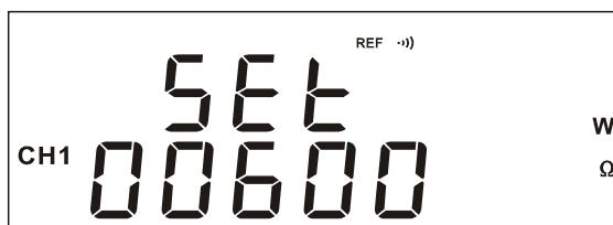
短按左键、右键移动编辑位，短按上键、下键编辑数字，短按OK键保存结果并退出编辑界面，短按ESC键取消并退出编辑界面。参考电阻值设置范围：1—1000欧。
