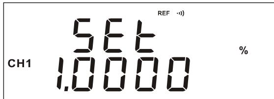
短按左键、右键移动编辑位，短按上键、下键编辑数字或移动小数点，短按OK键保存结果并退出编辑界面，短按ESC键取消并退出编辑界面。当选中最后一位时，再次短按右键可以切换单位；当选中第一位时，再次短按左键可以切换正负号。百分比参考值设置范围：-100M—100M。
