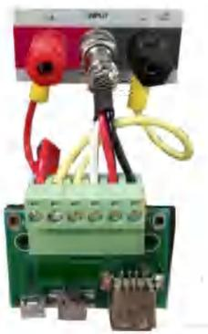
图1-2-3 UTL8511C接线柱及快充测试板连接配合图
