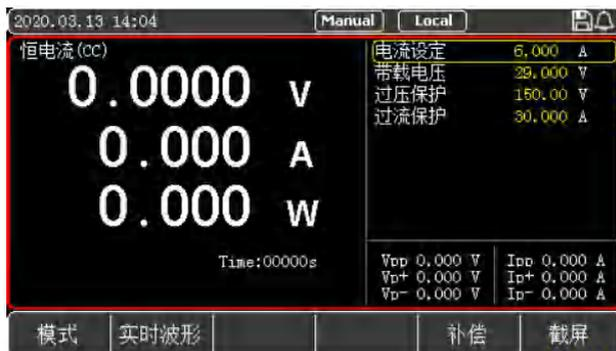
图4-1-1-1 恒电流CC设置界面
