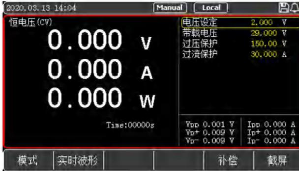
图4-1-2-1 恒电压CV设置界面
