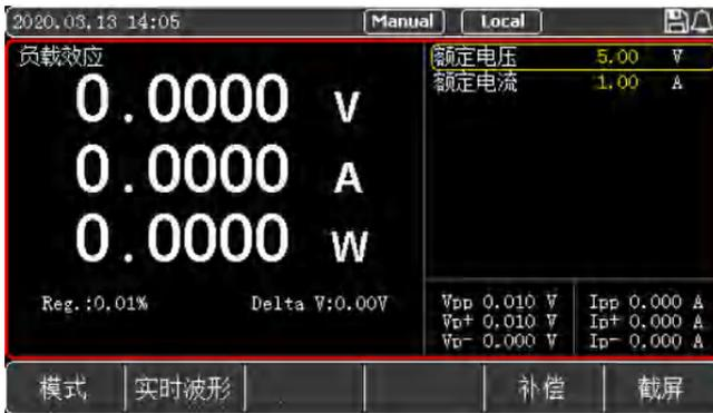
图4-2-7-1 负载效应测试模式界面
