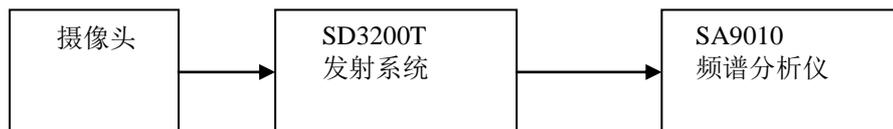
图 7 发射系统的输出载频和输出功率的测试框图
