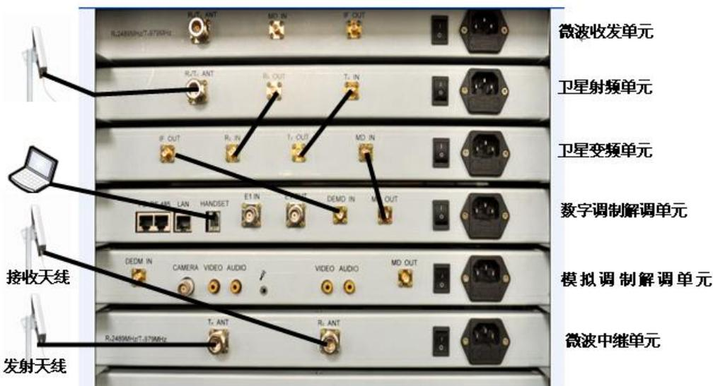
图（5.7）地球站 B 的微波中继通信实训系统的连接示意图
