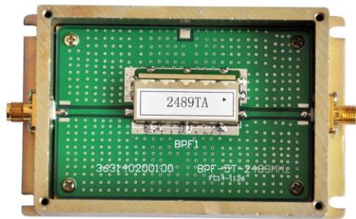
图 (3.38) 五腔滤波器 (2489MHz) 电路示图
