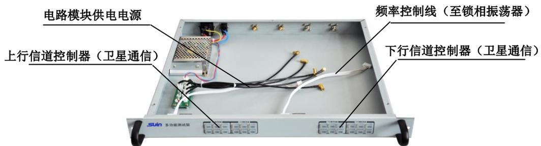
图（3.40） 多功能测试架内部示图
