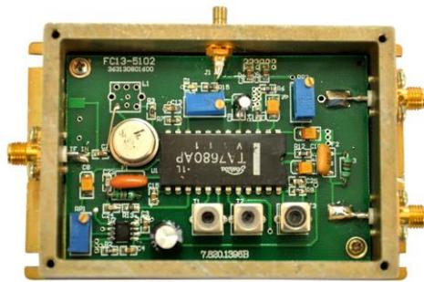
图 (3.20) 模拟解调器电路模块示图
