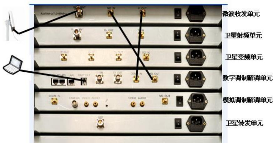
图 (5.1) 地球站 A 的数字微波通信实训系统的连接示图
