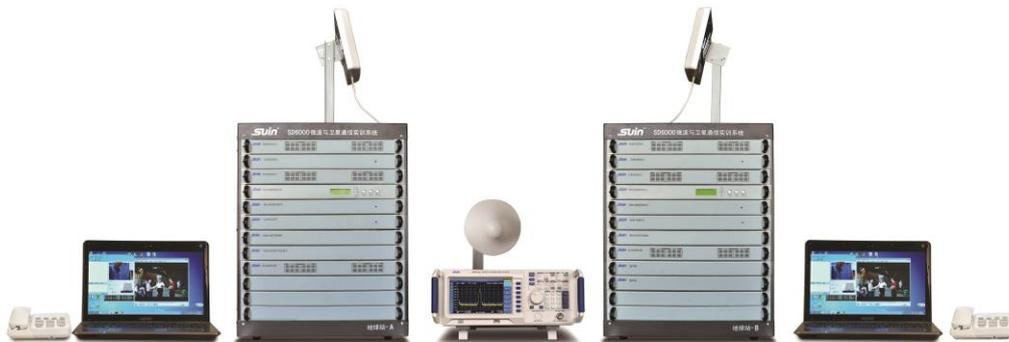
图（1.1） 整机组成示图（整机不包括频谱分析仪）
