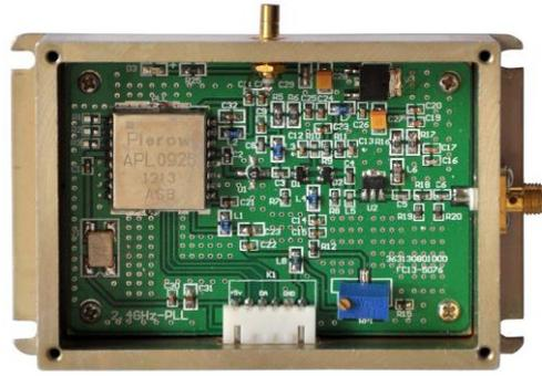
图 (3.28) 锁相振荡器 (890-960MHz) 电路模块示图
