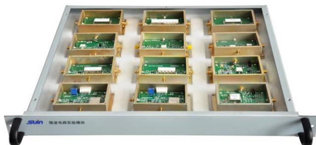
图（3.25） 微波电路实验模块内部电路分布图
