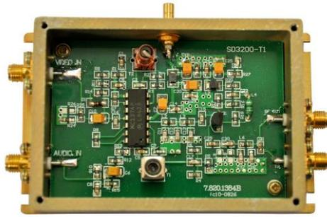
图 (3.19) 模拟调制器电路模块示图
