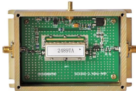
图 (3.31) 驱动放大器 (2489MHz) 电路模块示图
