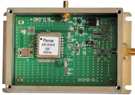
图 (3.26) 锁相振荡器 (1510MHz) 电路模块示图
