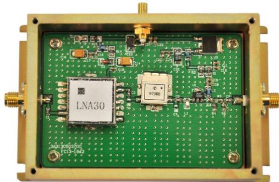
图 (3.29) 低噪声放大器电路模块示图
