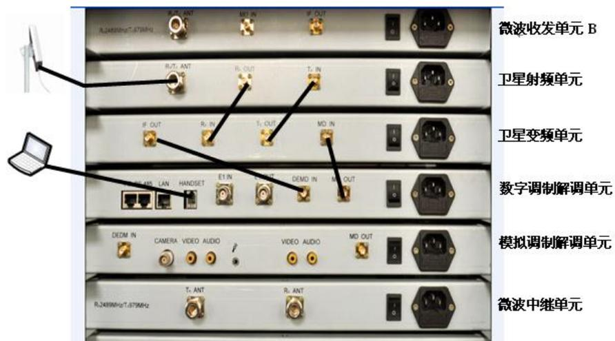
图 (5.4) 地球站 B 的卫星通信实训系统的连接示意图
