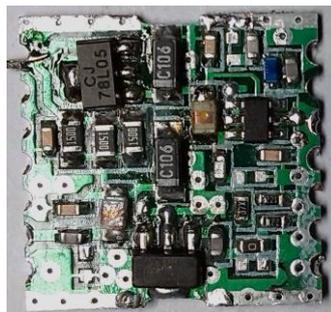
图 (3.30) LAN-30 低噪声放大组件示图
