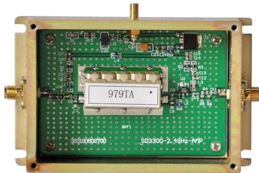
图 (3.32) 驱动放大器 (979MHz) 电路模块示图
