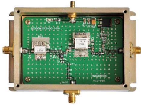
图 (3.33) 变频器 (2489-979MHz) 电路模块示图
