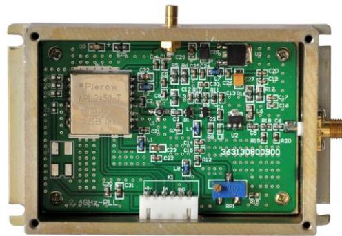
图 (3.27) 锁相振荡器 (2.4-2.5GHz) 电路模块示图
