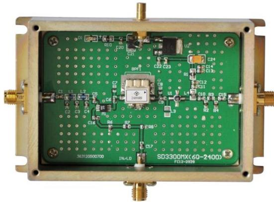
图 (3.34) 上变频器 (70-2489MHz) 电路模块示图
