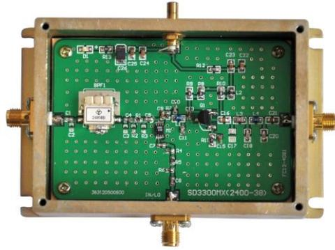
图 (3.35) 下变频器 (979-70MHz) 电路模块示图
