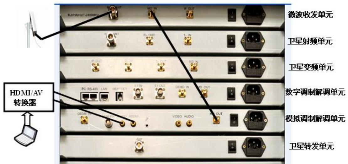
图（5.8） 地球站 A 的模拟微波通信实训系统的连接示意图
