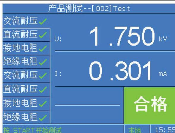
图 4-3-4 测试完成后显示单步结果
