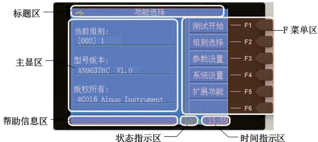
图 2-3-2 液晶面板示意图
