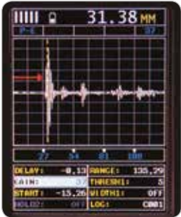
PE 脉冲-回波模式 标准显示模式，测量从传感器探头基体到材料密度边界（通常是背面）的总厚度。适合凹洞和瑕疵的检测。
