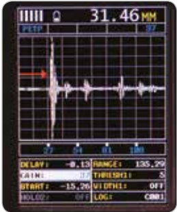
PETP 脉冲-回波温度补偿模式 与PE模式类似，PETP考虑和补偿由于温度变化引起的测量变化。
