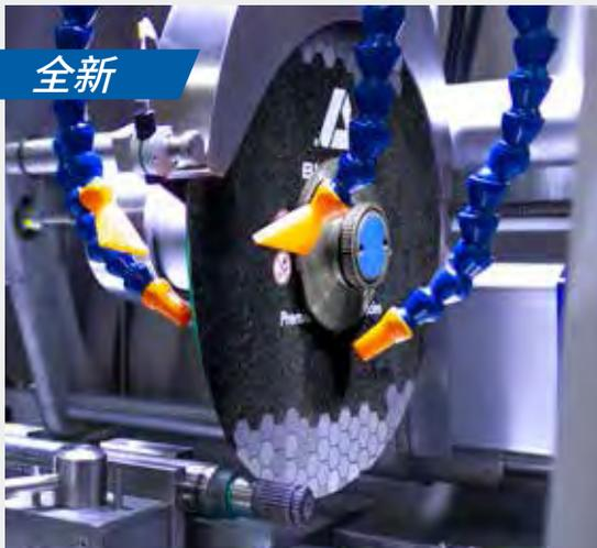
标乐的新型树脂切割片专门用于切割各种金属材料。新型切割片的一致性保证了切割质量, 延长的使用寿命则可以减少切割片的更换和购买次数, 以改进您的试样制备过程。
