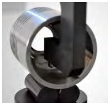
鹅颈压头适配器 适用于圆筒形件或轴等的内部测试 编号: W2100G5
