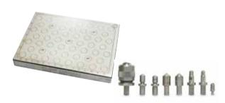
硬度块和压头 标乐提供各种高质量Wilson hardness标准硬 度块,所有经认证的标准硬度块都附上ASTM E384, ASTM E18, ASTM E10, ISO 6507, ISO 6508, 或ISO 6506校验证书。洛氏C标准硬度 块可直接NIST溯源。所有校验证书都符合ISO/ IEC 17025国际公认标准。
