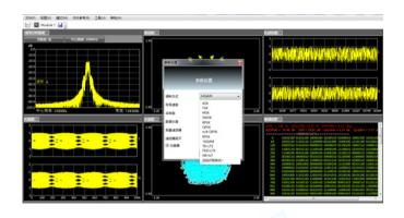
近年来,通信行业蓬勃发展,无线电环境也因此日益复杂化,这对无线电监测相关部门的监测工作提出了更高的要求,即从频谱监测升级到信号识别和分析。创远的全制式信号分析软件,是一款为应对无线电监测行业信号识别分析需求而诞生的专项软件平台。依托于创远仪器在信号源、信号分析仪、综测仪等通用仪表研发的多年耕耘和沉淀,整合相关技术积累,与公司无线电监测部门相配合,确定需求,不断地打磨,最终创新性地将以往软硬件结合的信号分析识别方案发展为兼容标准接收机 I/Q 数据流的纯软件方案。
