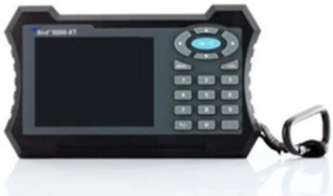
数字功率显示器 5000-XT 是全新设计的一款手持式数字功率计，非常适合工程现场的测量与读数。数字功率显示器 5000-XT 配合多种数字功率传感器使用，可测量 VSWR、平均功率、峰值功率、突发平均功率、峰均比、CCDF 等指标。数字功率显示器 5000-XT 可应用于各种蜂窝基站，如 WiMAX、CDMA、CDMA1X、EVDO、WCDMA、GSM/EDGE、TD-SCDMA、TETRA 等；另外，5000-XT 在航空电子、军事、模拟 / 数字音视频广播等领域也有广泛应用。
